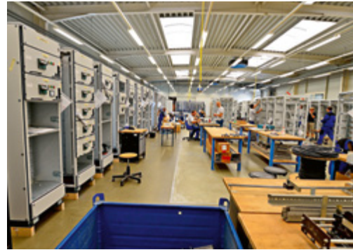
Montážna hala prevádzky výroby rozdávčov
